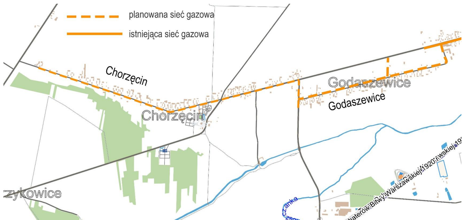
Schemat sieci gazowej w miejscowościach Godaszewice, Chorzęcin
